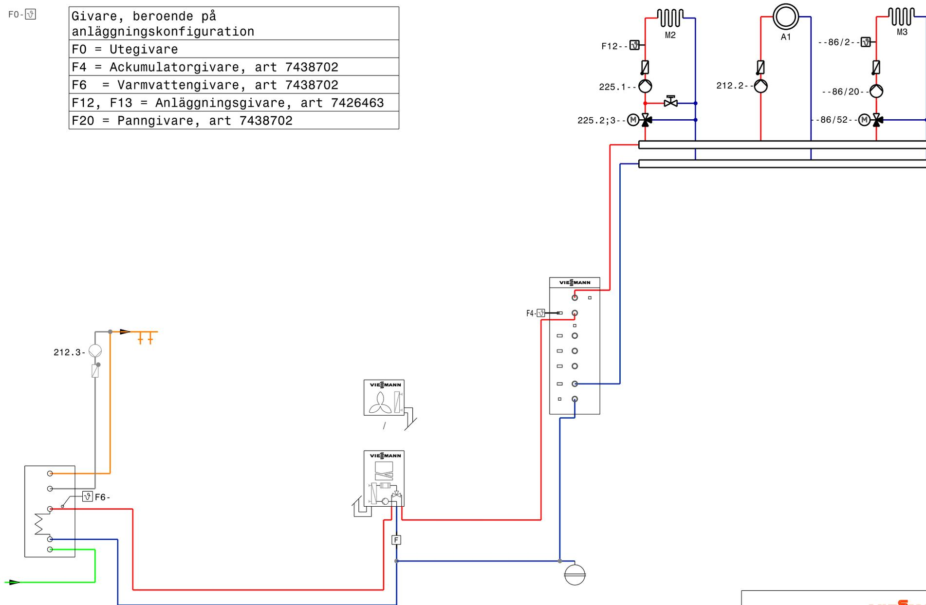
Principschema. Kontrolleras och godkännes av beställare eller beställarens ombud.
